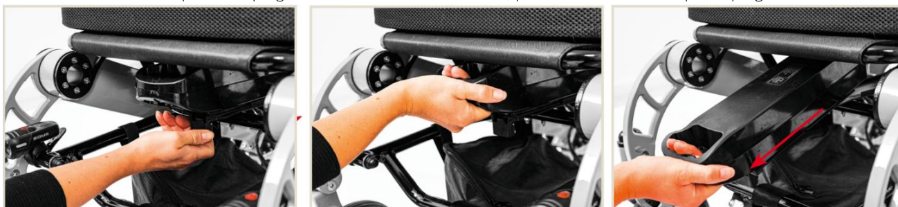
Figure 11 : Retirer la batterie en 3 étapes
