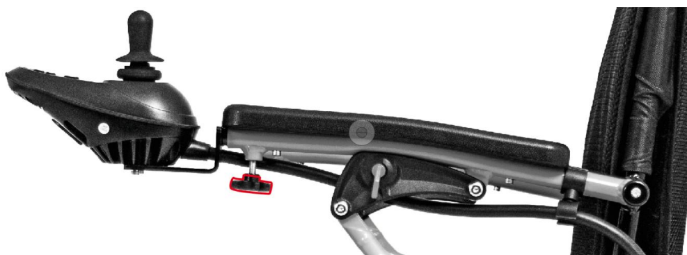
Figure 7 : molette de serrage et branchement du boîtier de commande
