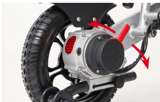
Figure 17 : activation ou désactivation des freins électromagnétiques
