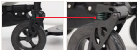
Figure 4: Les suspensions de la fourche avant de l'ergoflix Heavy
