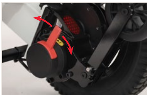
Figure 14: Activation ou désactivation des freins électromagnétiques
