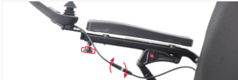
Figure 7: Fixation et connexion du boîtier de commande
