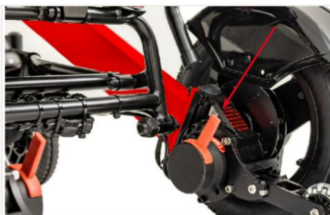
Figure 13 : emplacement des freins électromagnétiques
