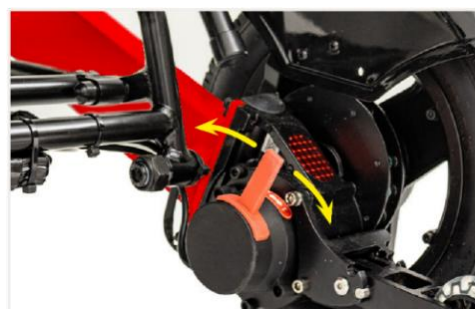
Figure 14 : activation ou désactivation des freins électromagnétiques
