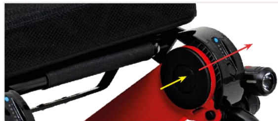
Figure 9 : remplacement de la batterie
