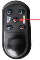
Illustration 8 : Klaxon - touche centrale sur le boîtier de commande
