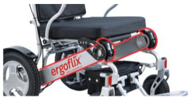
Illustration 3 : Logements des batteries de l'ergoflix
