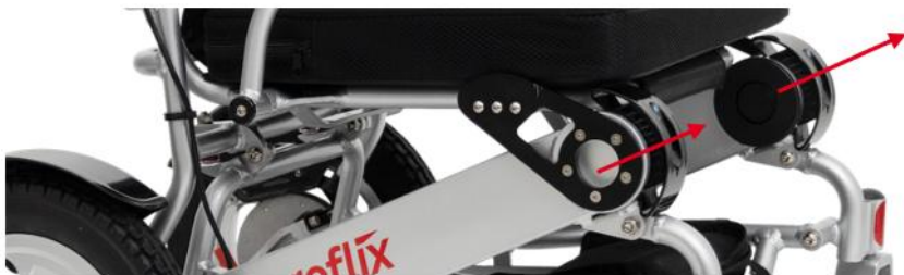
Illustration 12 : remplacement de la batterie
