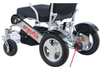
Illustration 14 : emplacement des freins électromagnétiques
